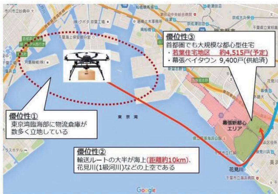
■図9. 千葉県幕張市のドローン搬送実験（千葉市資料）
