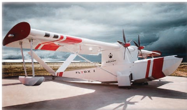
■写真1. Singular Aircraft社の「FLYOX I」は全長約12m、翼長14m、高さ3.6mの水陸両用無人機 出典：同社ホームページ
