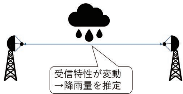
■図5. 固定無線システムを利用した降雨観測の概念
